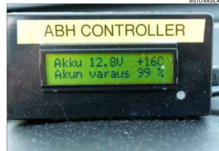
Mitautietoa akun tilasta. Ulkona -22 pakkasta, akun lämpötila 16 ja varaustaso 99 prosenttia.
